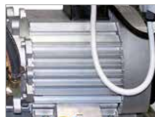
VEDLIKEHOLDSFRI ELEKTRISK MOTOR, LUFTAVKJØLT OG MED TERMISK BESKYTTELSE
