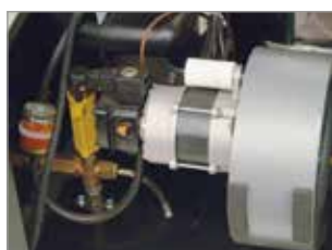
EN-FASET MOTOR KOBLET TIL VIFTE OG DIESELPUMPE
